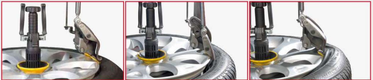
Procedura demontażu górnej stopki opony
